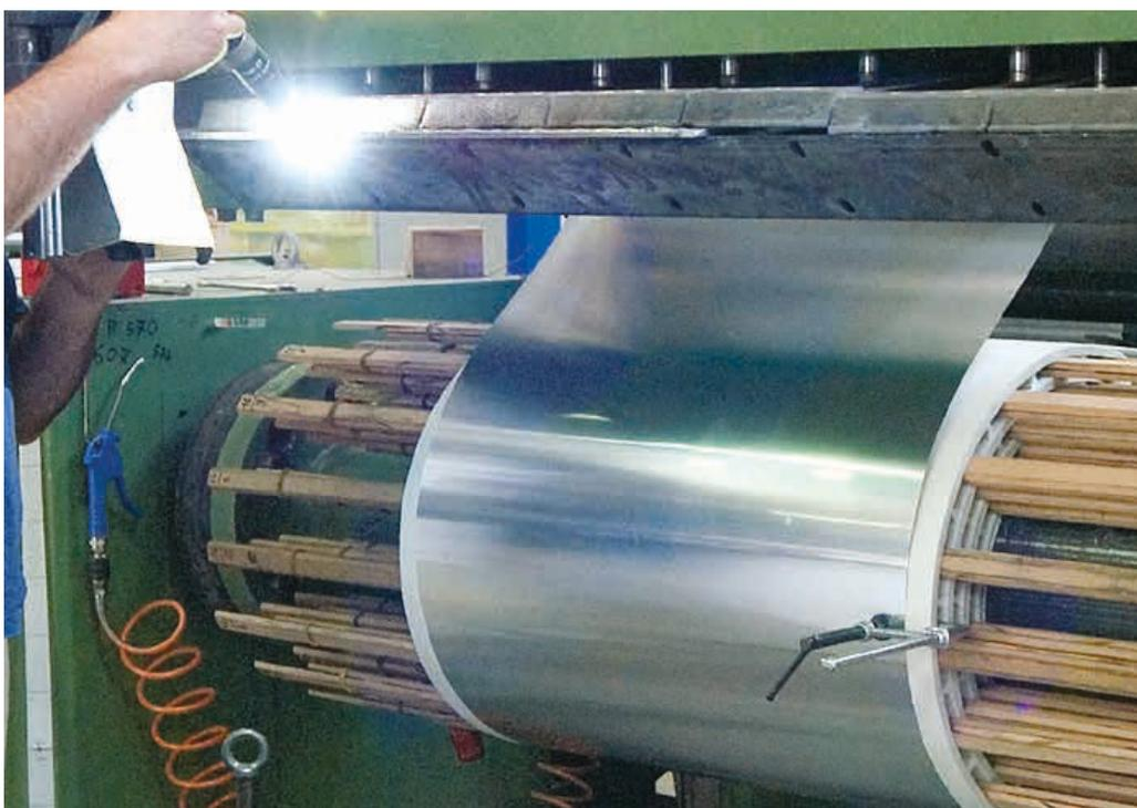
Soldadura TIG en atmósfera controlada para las conexiones de BT.
