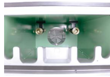
Compartimento de aire comprimido y agua.
